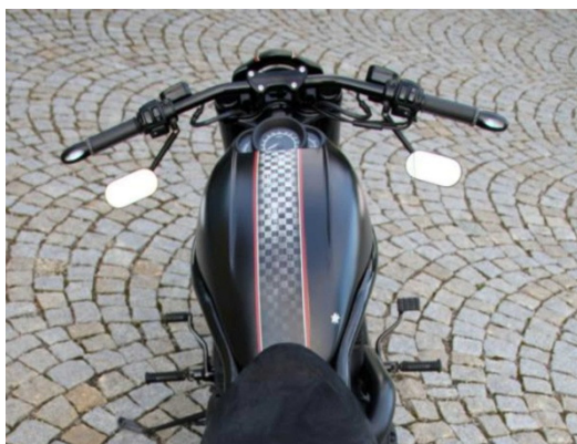
Abb. 1 – montiertes Airbox Cover mit verbautem Tacho
