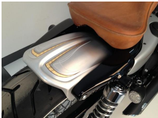
Abb. 1 – montierter Fender, Fender Struts und Blinker
