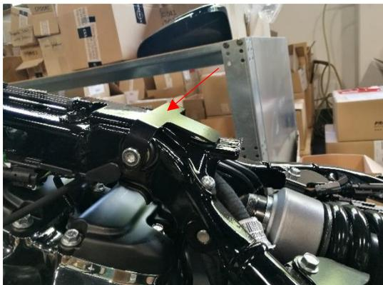
Abb. 9 – montierter Auflagebügel
