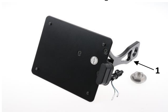
Abb. 4: seitlicher Kennzeichenhalter mit Klemmmutter
