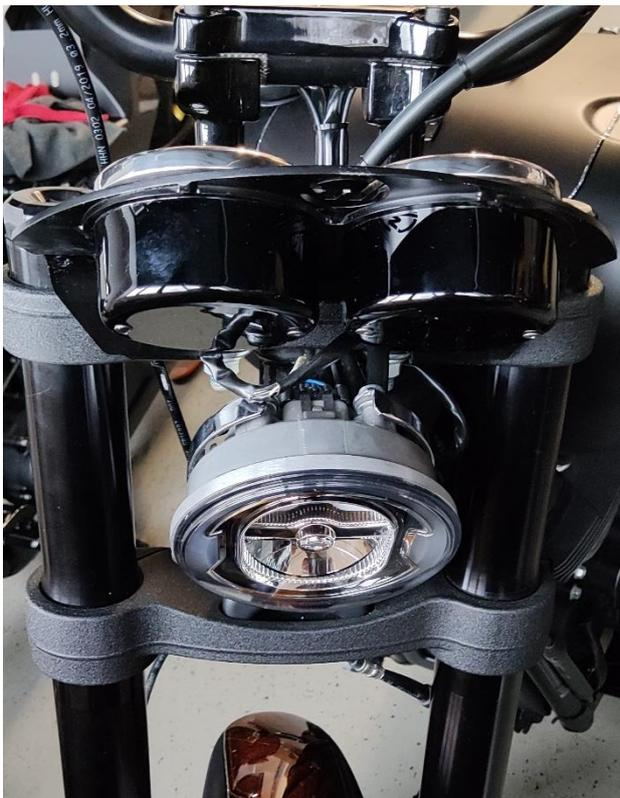
Abb. 2, montierter Tachoversatz mit Abdeckungen
