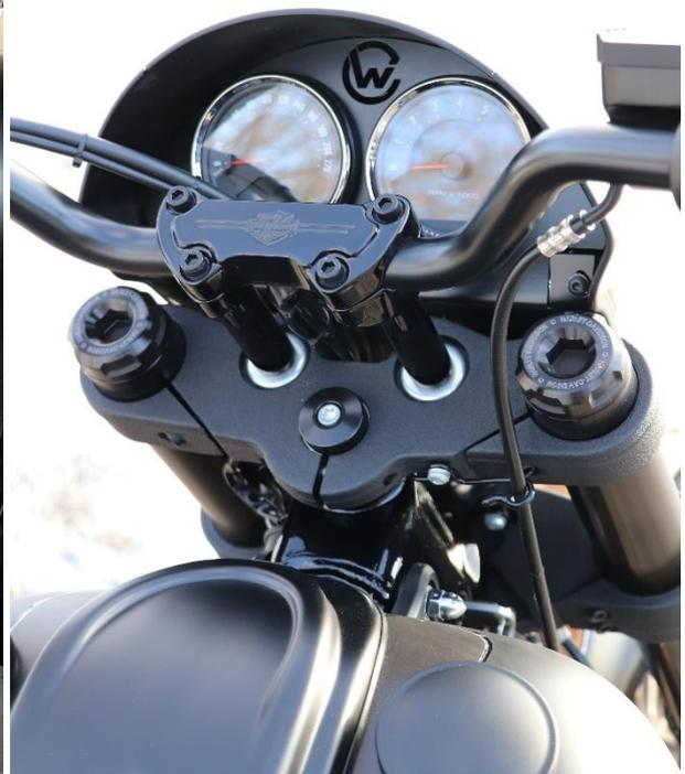
Abb. 3, montierter Tachoversatz mit Maske
