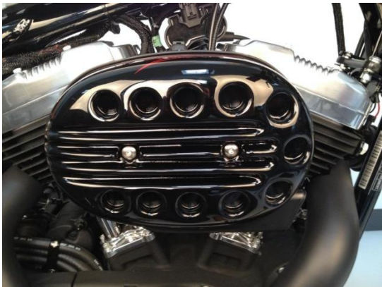
Abb. 1 – montierter Luftfilterdeckel „Slotted“
