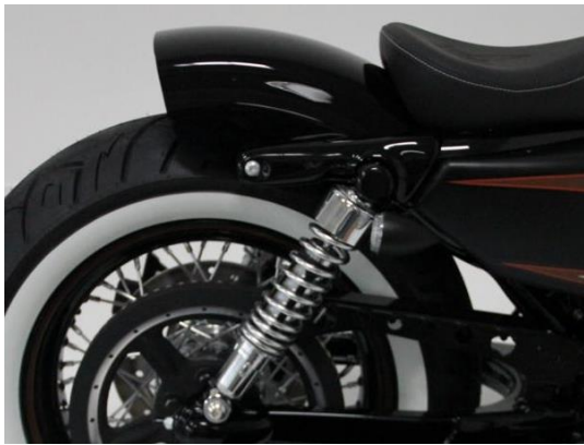
Abb. 1 – montierter Fender, Fender Struts und Blinkerset
