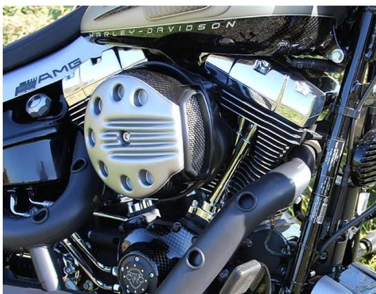
Abb. 1 - montierter Luftfilterdeckel
